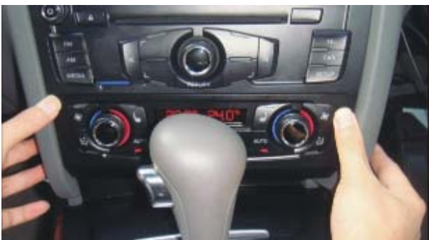
27. Установите панель управления кондиционера.
