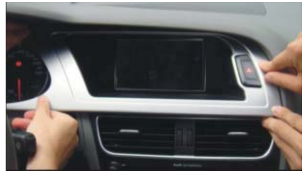
36. Подсоедините остальную проводку к декоративной панели экрана и установите ее на место, надежно зафиксировав.
