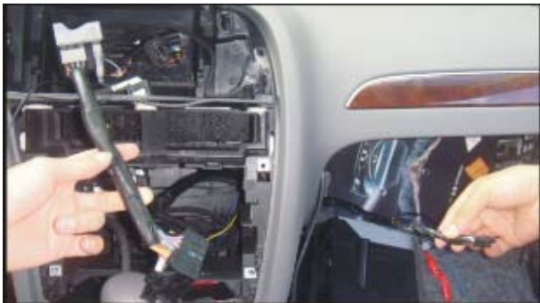
23. Разместите проводку головного устройства так, как показано на фото.
