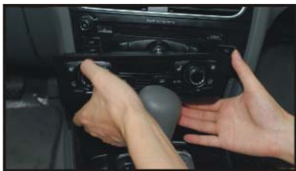
7. Выньте панель управления кондиционером.
