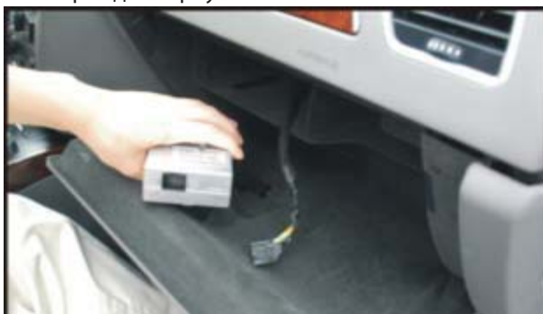
15. Снимите блок аудиосистемы, отсоединив проводку.
