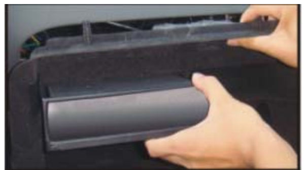
14. Снимите блок аудиосистемы, отсоединив проводку.
