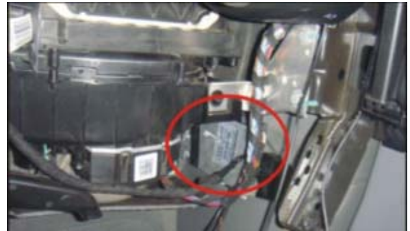
22. Разместите блок аудиосистемы вместе с проводкой так, как показано на фото.
