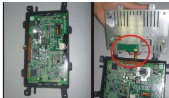
32. Установите штатный экран и микросхему в сенсорный экран GPS модуля и подсоедините плоский провод сенсорного экрана к небольшой микросхеме так, как на фото.
