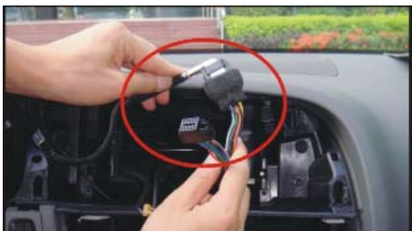
29. Подсоедините разъем штатного экрана к специальному разъему GPS экрана.
