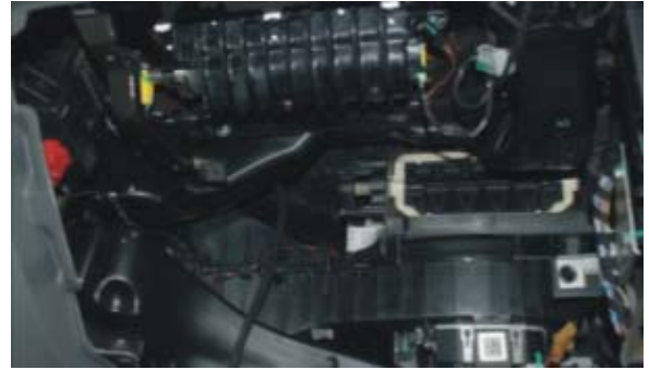
18. Снимите перчаточное отделение.
