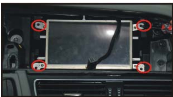
5. Открутите винты, фиксирующие экран.
