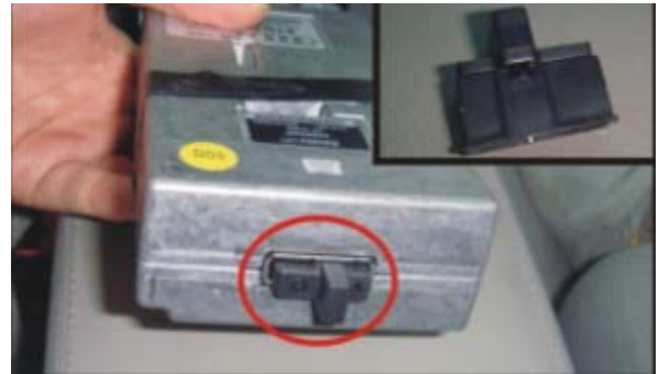
20. Вставьте специальный разъем для мультимедиа в гнездо (убедитесь в правильности подключения).
