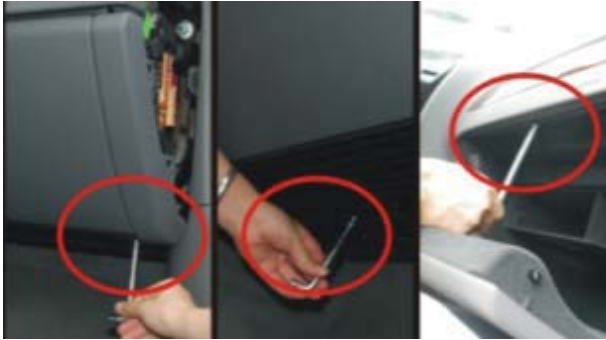
17. Открутите винты перчаточного отделения головкой М8.
