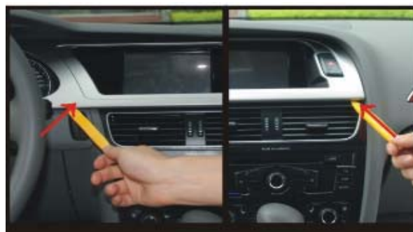
2. С помощью монтажных лопаток демонтируйте декоративную панель, не повреждая крепеж.
