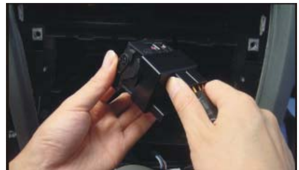
24. Подсоедините разъем штатного головного устройства к разъему GPS модуля.
