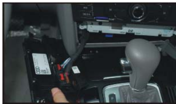
8. Разместите снятую панель управления так, чтобы не повредить ее во время дальнейших работ.
